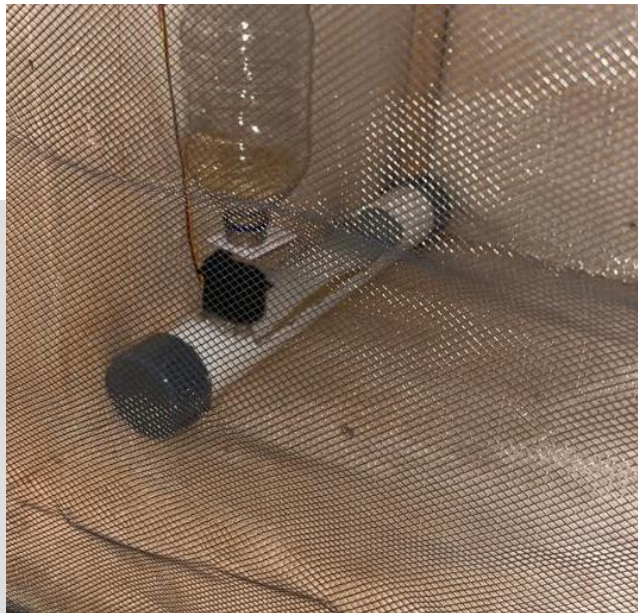
Gambar 11. Kondisi servo membuka pakan
