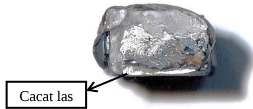
Gambar 14 Patahan Pada Arus Pengelasan 80 A
