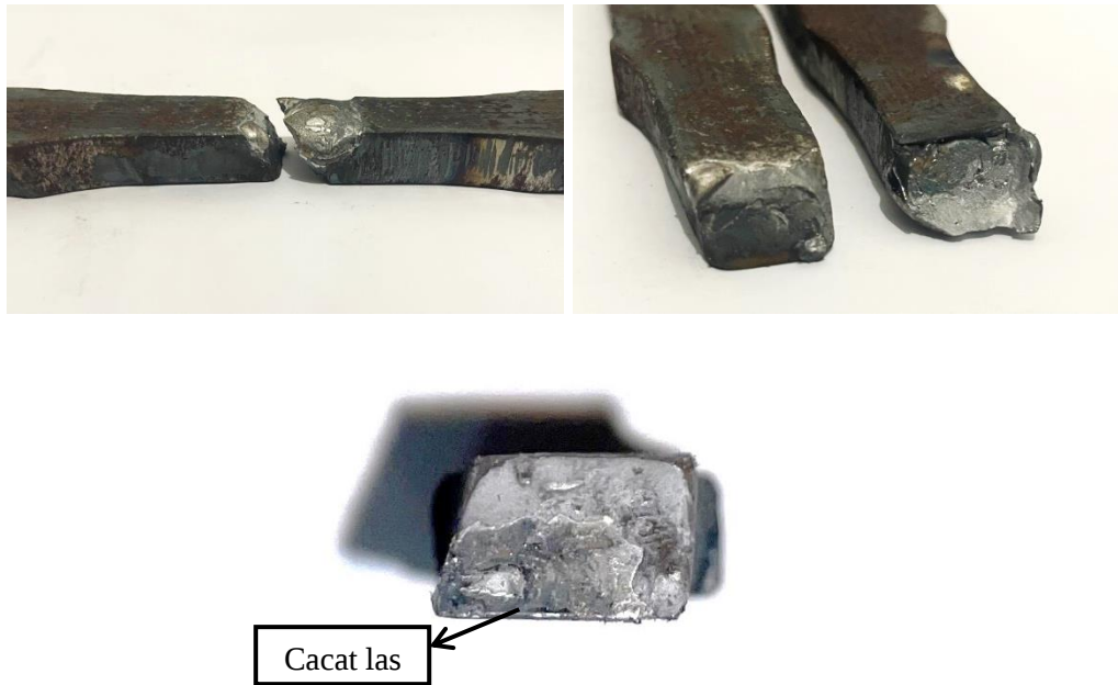
Gambar 16 Patahan Pada Arus Pengelasan 100 A
