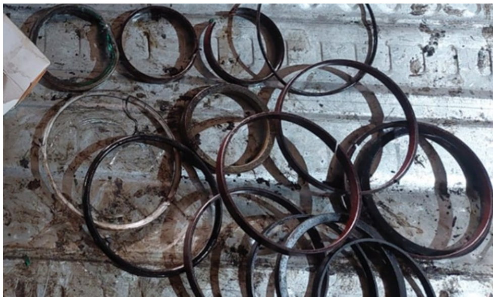
Gambar 2 Seal yang mengalami kerusakan
