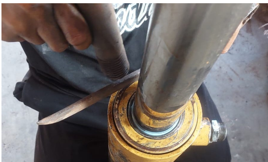
Gambar 10 Pemasangan Guide Sub Assy pada Tabung Cylinder
