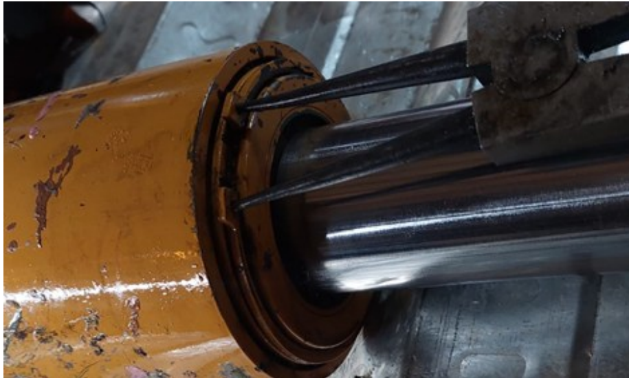
Gambar 11 Pemasangan Ring Circlip
