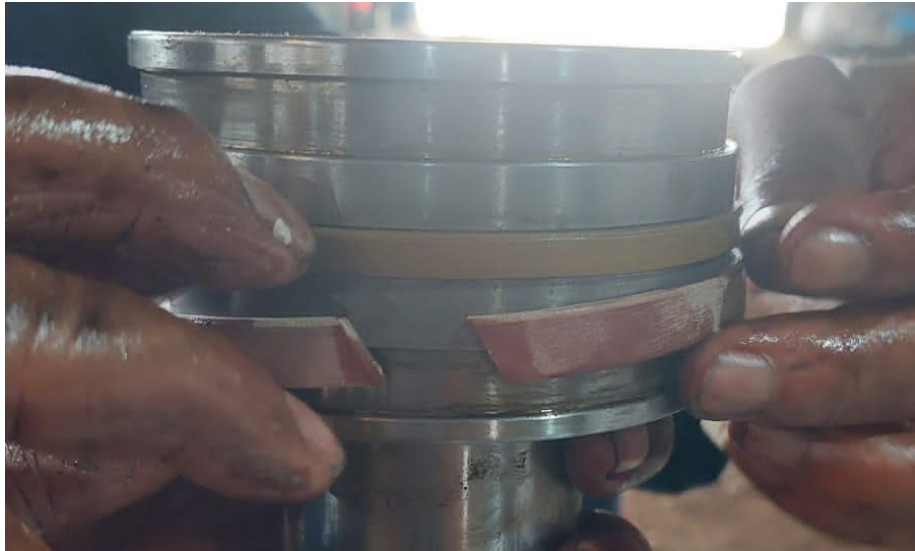
Gambar 3 Pemasangan Seal pada Piston
