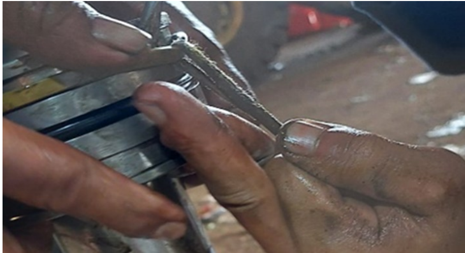
Gambar 8 Pemasangan Bolt Pengunci dan seal pada Piston
