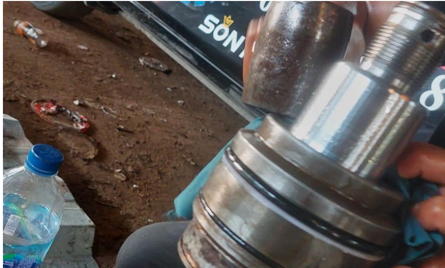
Gambar 5 Pemasangan Guide Sub Assy pada Rod
