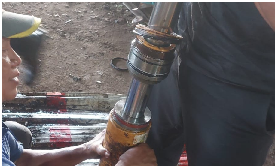
Gambar 9 Pemasangan Rod Pada Tabung Cylinder
