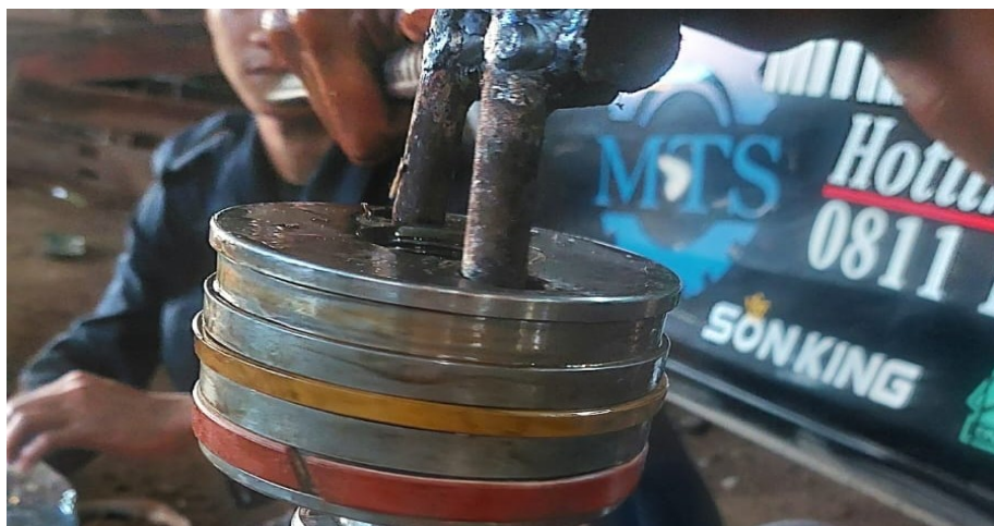
Gambar 7 Mengencangkan Piston pada Rod dengan menggunakan Special Tools
