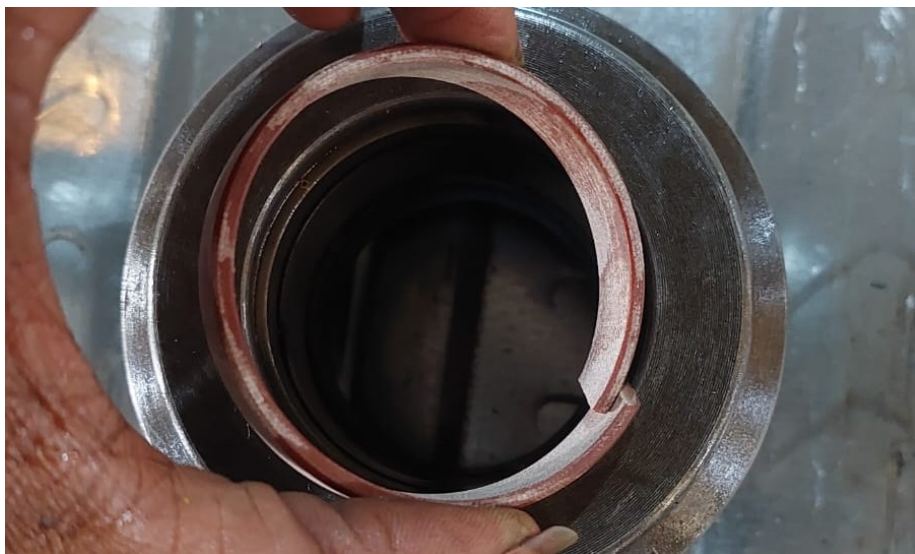
Gambar 4 Pemasangan Seal pada guide sub assy
