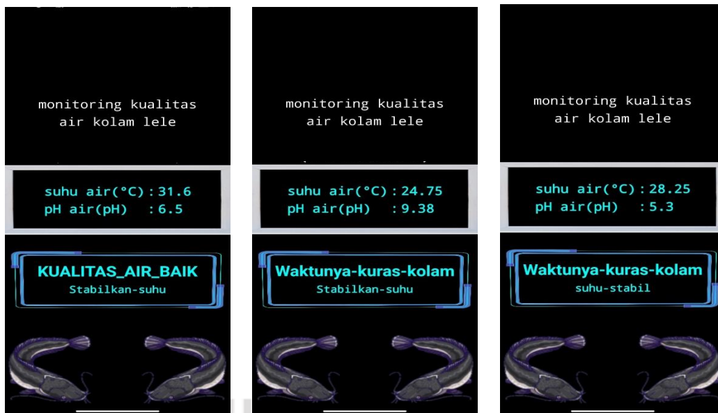
Gambar 7. Aplikasi Sistem monitoring kualitas air kolam lele
