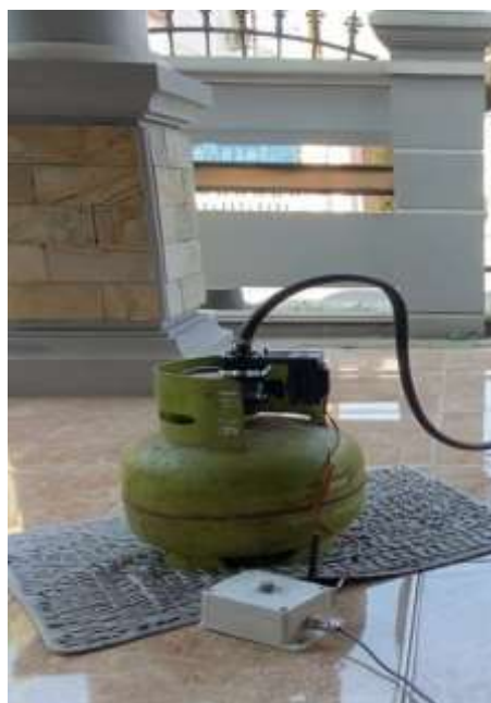
Gambar 8. Pemasangan Alat pada Gas LPG
