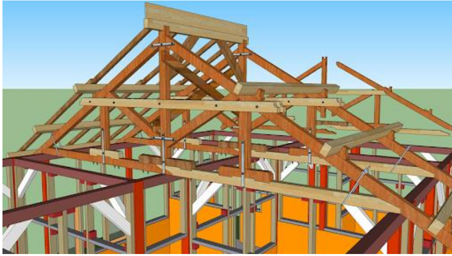
Gambar 9 Struktur rangka atap kuda kuda Sumber : interiordesign.id, 2023
