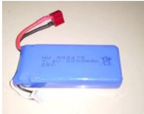
Gambar 9. Baterai 7,4 Volt 2 Ah
