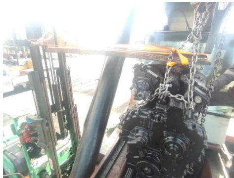
Gambar 3.12 proses pengangkatan gearbox dari unit
