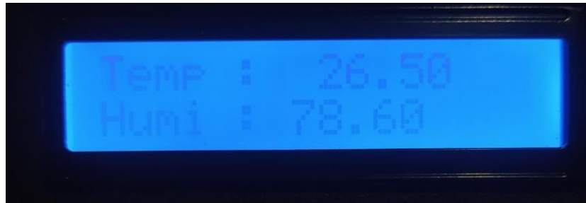
Gambar 4. Hasil Tampilan Pada LCD 16x2
