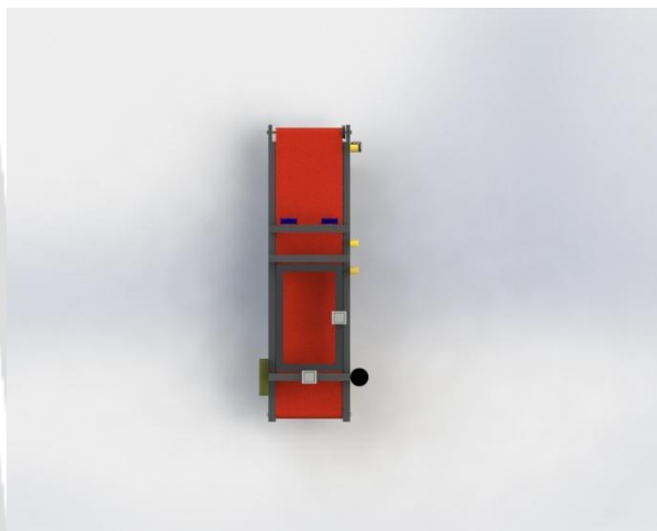
Gambar 6. Desain alat penabur benih sawi otomatis berbasis Arduino (Alat Tampak Atas)
