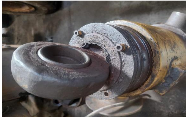
Gambar 3 Seal Pada Cylinder Hydraulic Yang Rusak
