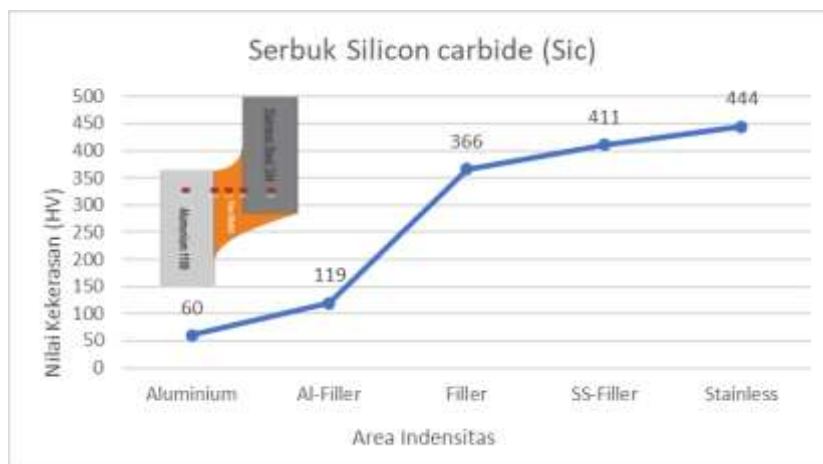
Gambar 14. Grafik Hasil Uji Kekerasan Spesimen Dengan Penambahan Serbuk SiC
