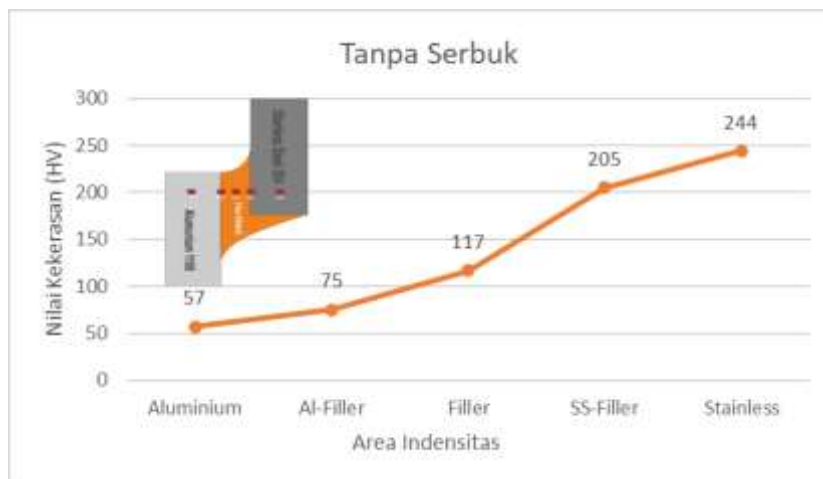
Gambar 13. Grafik Hasil Uji Kekerasan Spesimen Tanpa Penambahan Serbuk
