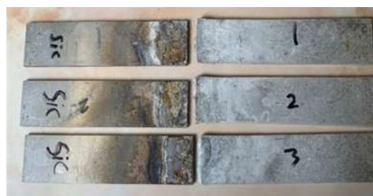
Gambar 12. Spesimen Hasil Pengujian Tarik dan Geser sambungan jenis Lap Joint dengan Serbuk SiC
