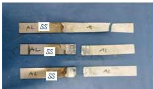
Gambar 11. Spesimen Hasil Pengujian Tarik dan Geser sambungan jenis Lap Joint Tanpa Serbuk SiC
