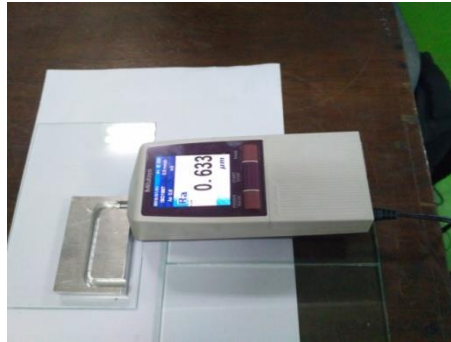
Gambar 3. 15 Setting Spesimen pada Alat Uji
