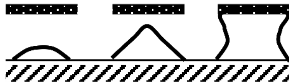
Gambar 6 Pembentukan Tombolo pada Pantai yang dipasang Breakwater
