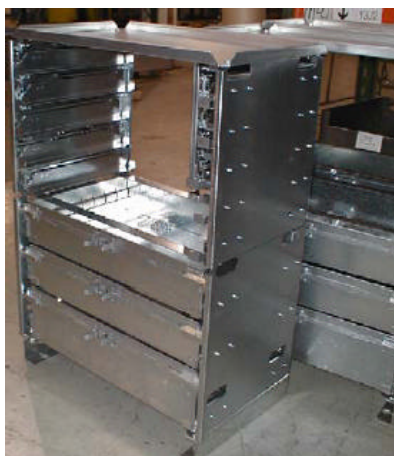
Gambar 1.1. Penggunaan las titik untuk lemari besi / locker
