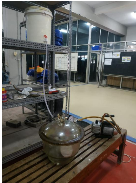
Gambar 1 Tahap Vacum Beton
