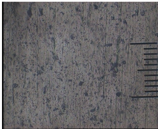
Gambar 1. Foto struktur mikro raw material dengan pembesaran 500×
