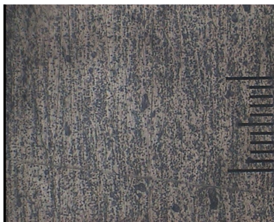
Gambar 2. Foto struktur mikro Al 2014 suhu aging 150°C dengan pembesaran 500×
