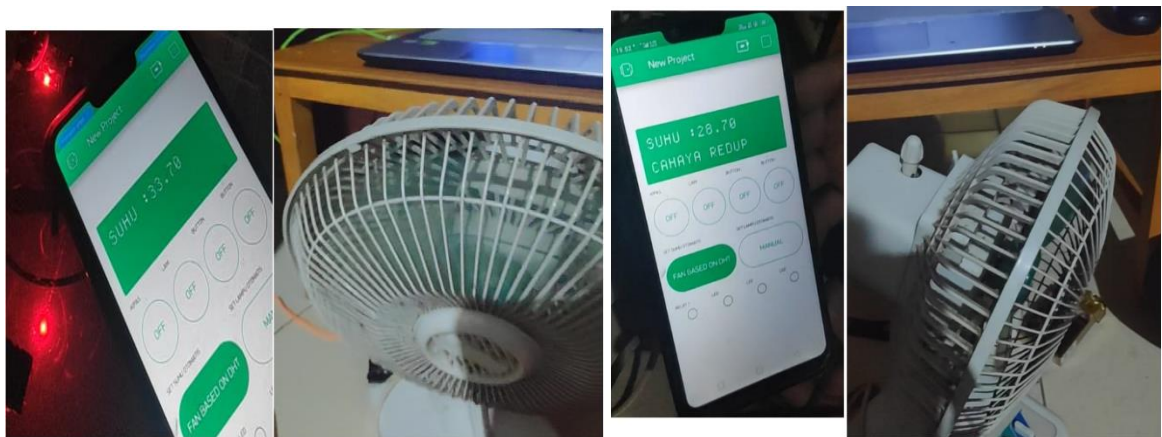
Gambar 7. Pengujian sistem otomatis kipas on/off kondisi malam hari.
