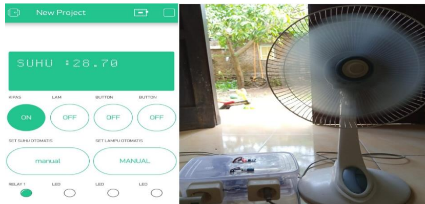
Gambar 10. Pengujian sistem manual kondisi kipas on .
