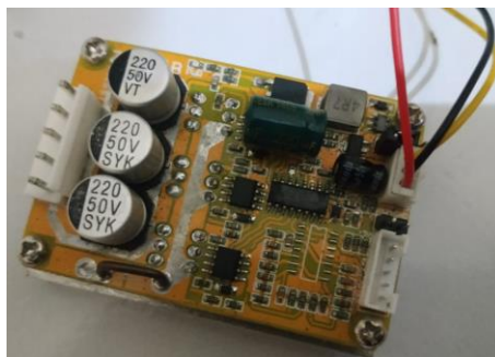
Gambar 6 Kontrol motor BLDC
