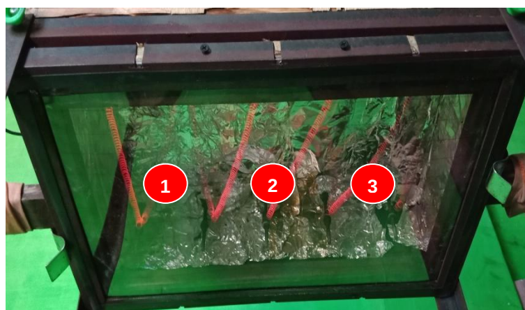
Gambar 21 Titik pengukuran suhu pada bahan polycarbonate
