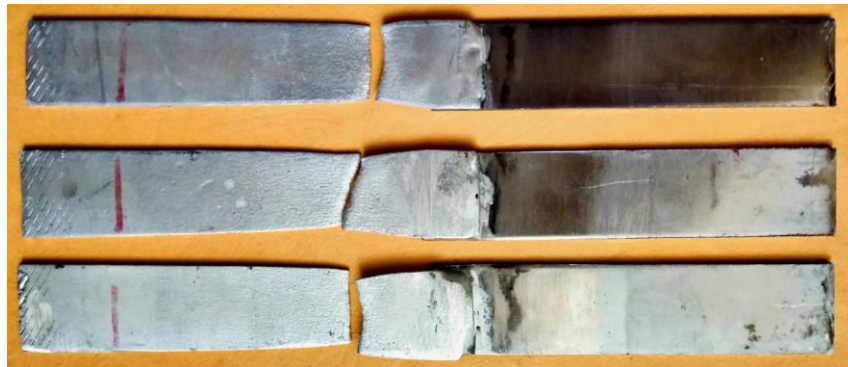
Gambar 4.4 Hasil pengujian tarik geser sambungan aluminium dan stainless steel tanpa penambahan filler serbuk magnesium
