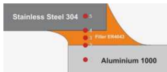
Gambar 14. Skema Titik Pengujian Kekerasan Mikro Vickers
