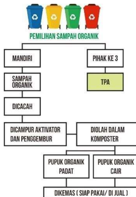
Gambar 4.14 Skema Pengolahan Limbah Organik (Sumber: Data Pribadi, 2020)
