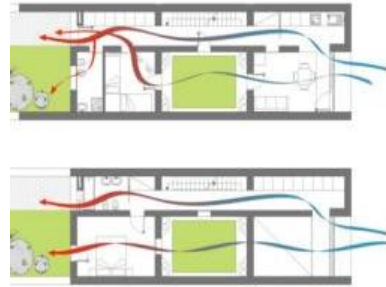
Gambar 4.13. Bukaan di fasad gedung
