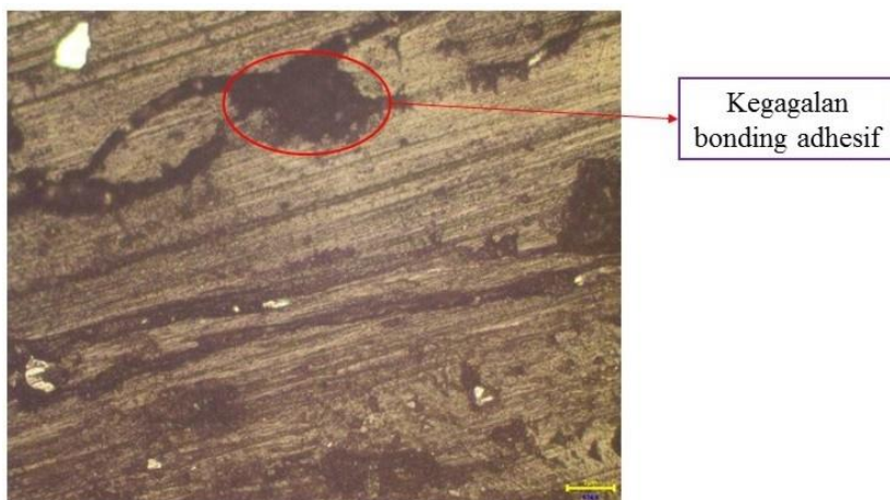
Gambar 9 Foto Mikro Mesh 70 Setelah Uji Gesek (Pembesaran 100x)
