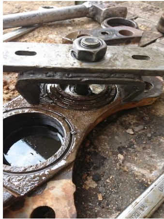
Gambar 8 Melepas piston rem
