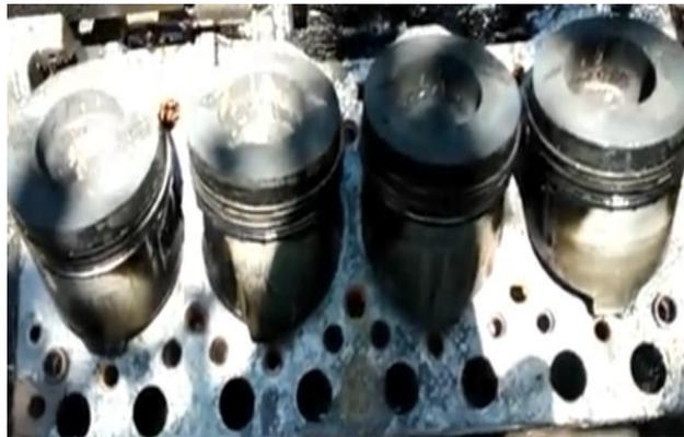
Gambar 18. *Ring piston dan piston Aus*
