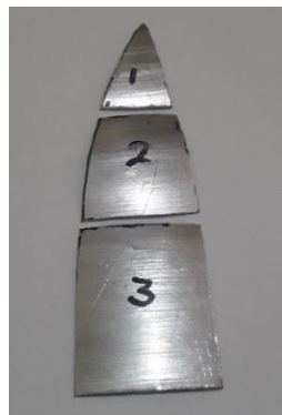
Gambar 3. Spesimen Uji Kekasaran
