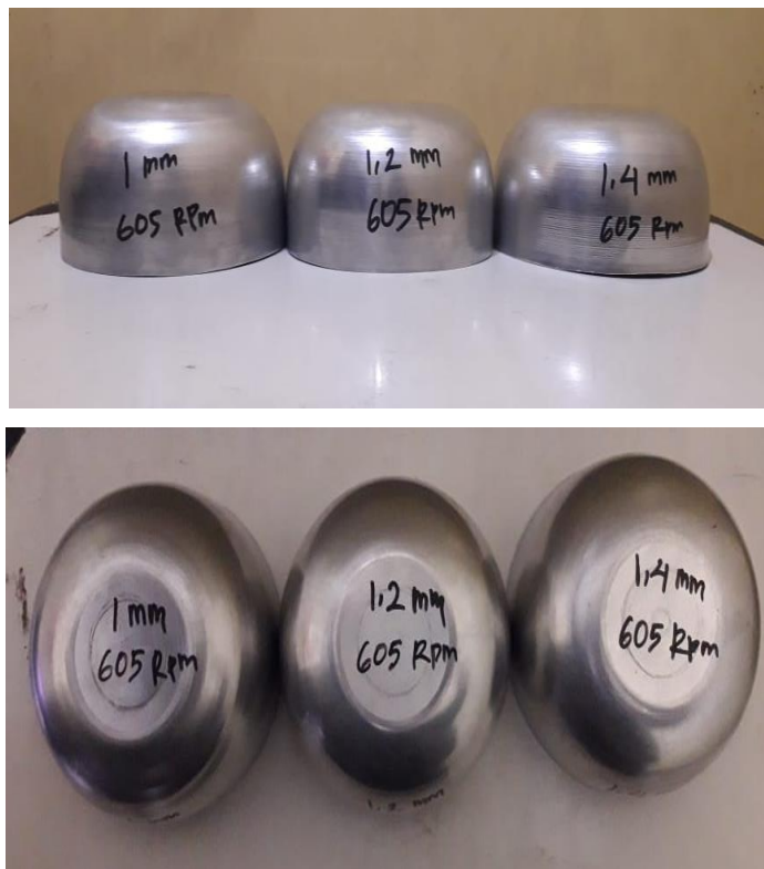
Gambar 2. Hasil Produk Metal Spinning Dengan Tebal Plat 1 mm, 1,2 mm, dan 1,4 mm.
