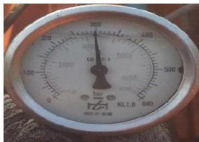
Gambar 4.3 Tekanan oli hydraulic tester 300 bar
