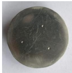
Gambar 2 Posisi titik untuk pengujian kekerasan Brinell
