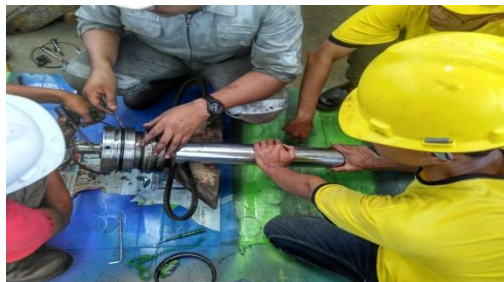
Gambar 1. Kerusakan Seal Piston
