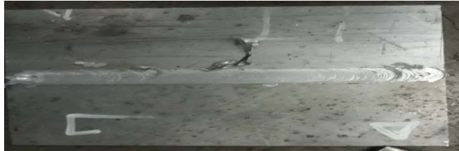
Gambar 2 hasil pengelasan baja AISI 4340
