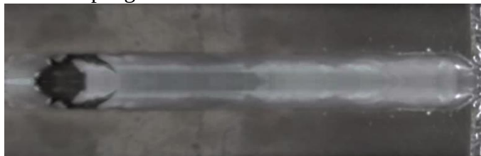
Gambar 4 Hasil pengelasan baja AISI D2
