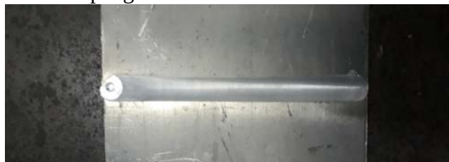
Gambar 3 Hasil pengelasan baja AISI O1
