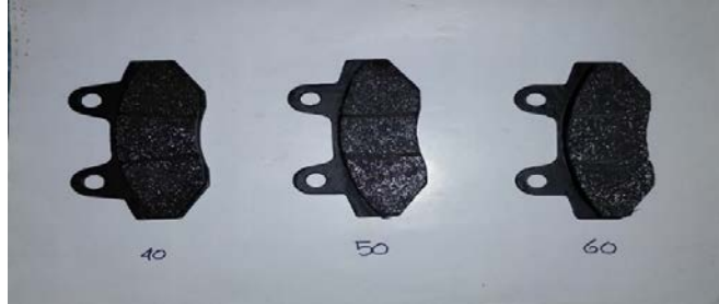
Gambar 2. Kampas Rem Variasi Ukuran Besar Butir Aluminium
