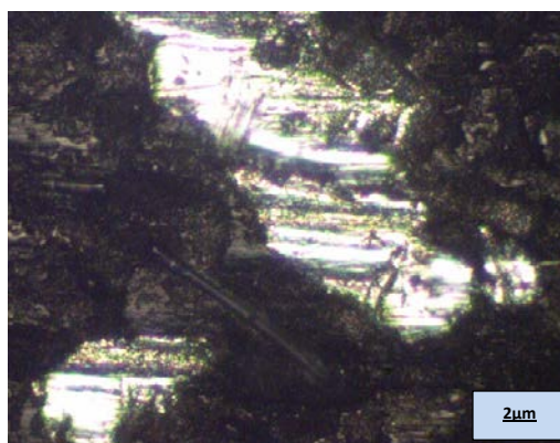
Gambar 27. Foto Mikro dengan Variasi Aluminium Mesh 40 Sesudah Uji Gesek Kering
