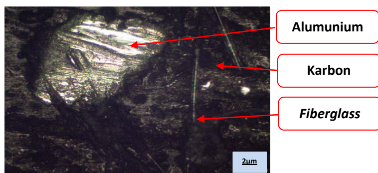
Gambar 7. Foto Mikro dengan Variasi Aluminium Mesh 40 Sebelum Uji Gesek Kering
