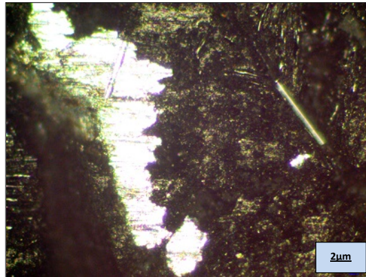
Gambar 43. Foto Mikro dengan Variasi Aluminium Mesh 40 Sesudah Uji Gesek Pengaruh Minyak Rem
