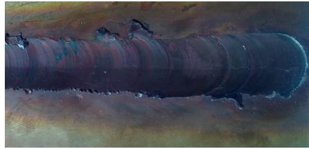
Gambar 4 Hasil pengelasan dengan material pin/ tool joint Baja D2
