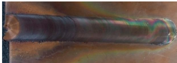
Gambar 3 Hasil pengelasan dengan pin/ tool joint Baja AISI 01
