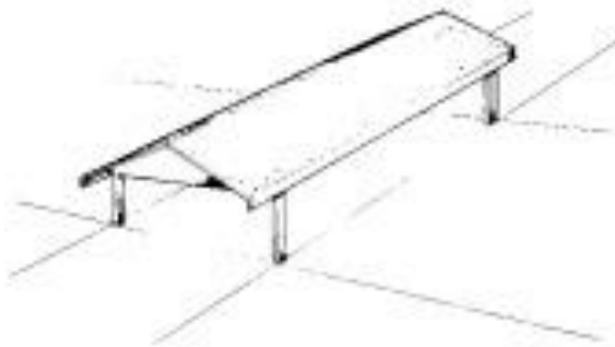
Gambar 25 Folded Plate Dua Segmen Sumber : R. Sutrisno. Bentuk Struktur Bangunan dalam Arsitektur Modern, 1982 dalam dlscrib.com_struktur-plat-lipat.pdf, 2019
