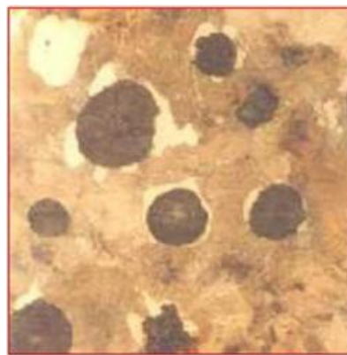
Gambar 5 Struktur Mikro Besi Cor Nodular
