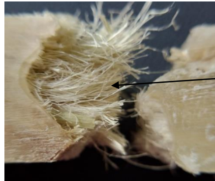
Gambar 13 Foto Makro Polipropilena tanpa perlakuan NaOH fv 60%
