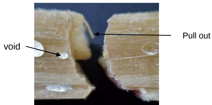
Gambar 6 Foto Makro Epoksi tanpa perlakuan NaOH fv 50%
