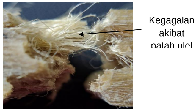
Gambar 11 Foto Makro Polipropilena tanpa perlakuan NaOH fv 40%
