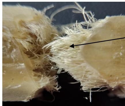
Gambar 15 Foto Makro Polipropilena dengan perlakuan NaOH fv 50%
