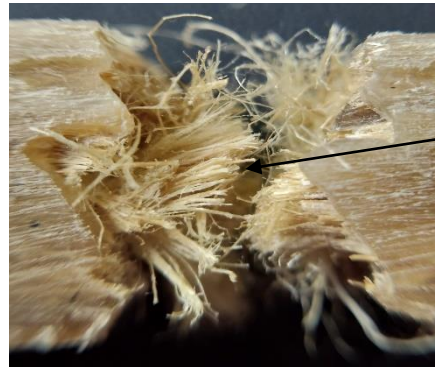
Gambar 16 Foto Makro Polipropilena dengan perlakuan NaOH fv 60%
