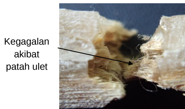
Gambar 12 Foto Makro Polipropilena tanpa perlakuan NaOH fv 50%
