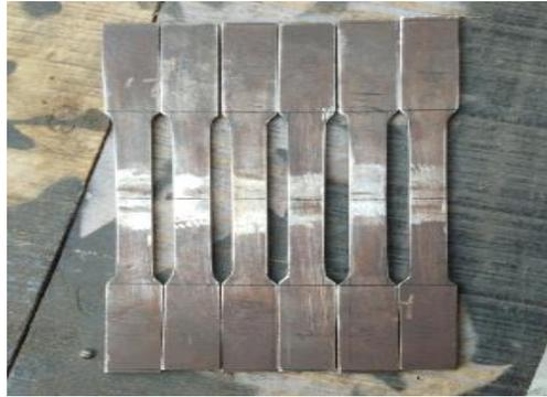
Gambar 7. spesimen uji tarik
