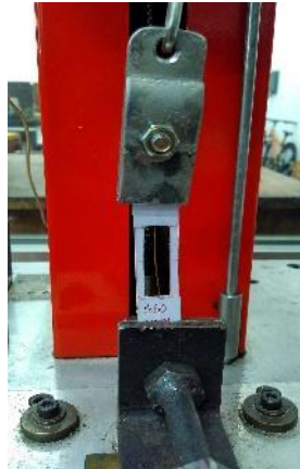
Gambar 3. Proses Pengujian Tarik Serat Tunggal
