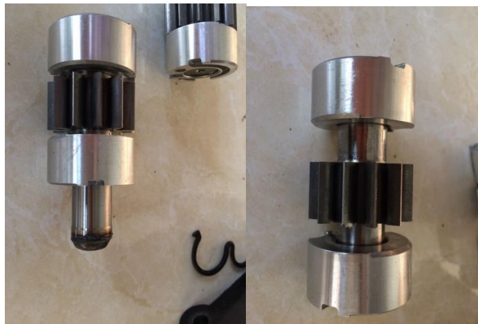
Gambar 9 Driver dan Idlear Gear mengalami Aus
