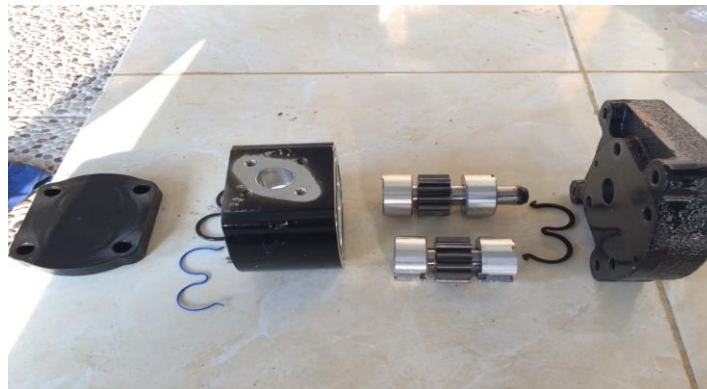
Gambar 7 Pembongkaran pompa hidraulik
