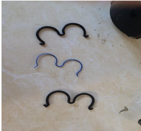
Gambar 10 kerusakan seal back up dan retainers
