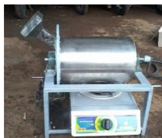
Gambar 4 Alat sangrai kopi dengan tuas pemutar
