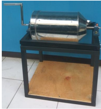
Gambar 6 Hasil pembuatan alat sangrai melinjo
