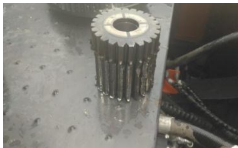
Gambar 17 Sun gear ke dua mengalami keausan.
