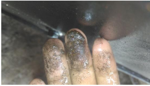
Gambar 16 gram pada dasar oil swing gear reduction .
