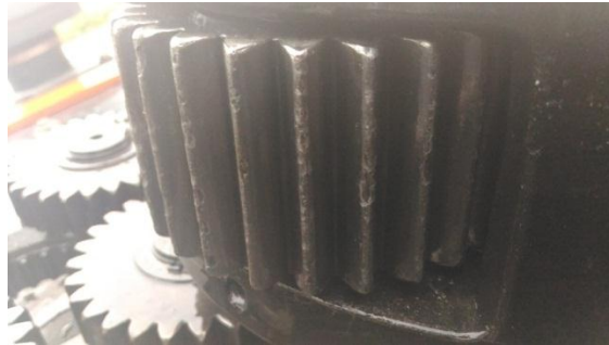
Gambar 21 Kerusakan sun gear ke dua swing reduction .
