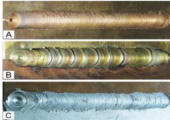
Gambar 2 Hasil pengelasan (A) pengelasan Cu-Cu (B) pengelasan Cu-CuZn (C) pengelasan Al-Cu
