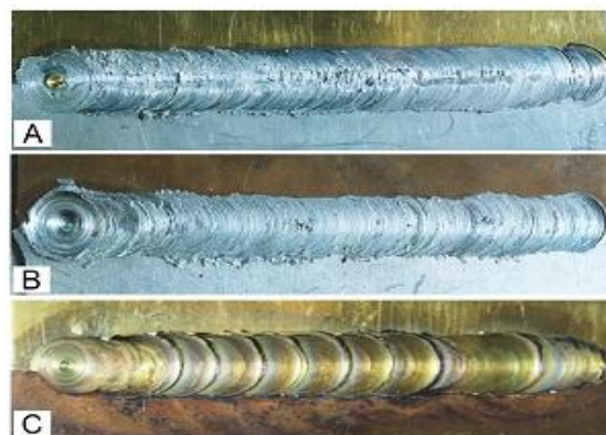
Gambar 2 Hasil Pengelasan FSW (A) Pengelasan Al-CuZn (B) Pengelasan Al-Cu (C) Pengelasan Cu-CuZn.
