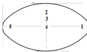
Gambar 9. Posisi Titik Uji Kekerasan Pada Spesimen
