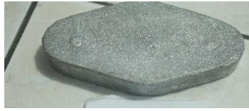
Gambar 1. Spesimen Pengujian Cacat Penyusutan
