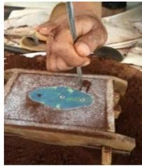
Gambar 7. Proses membuat saluran masuk
