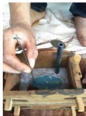
Gambar 6. Memasang saluran turun dan saluran buang
