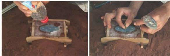
Gambar 8. Proses memberi air dan mengangkat pola
