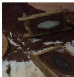
Gambar 12. Pembongkaran cetakan
