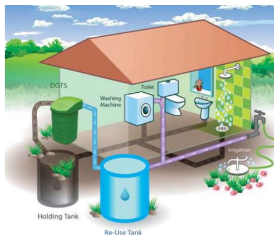
Gambar 3.32. Skema Sistem DGTS Sumber : spec-net.com.au
