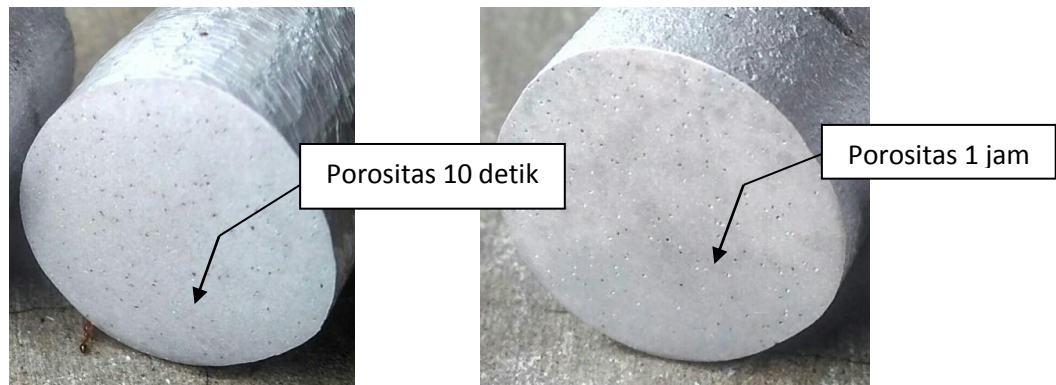
Gambar 4. 5 Porositas yang terlihat pada hasil cor
