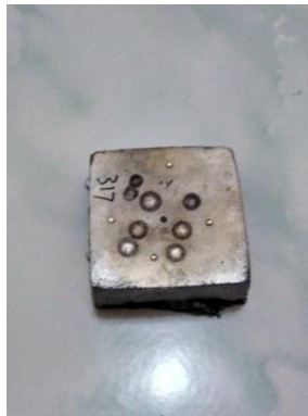
Gambar 4. 7 Titik uji komposisi kimia
