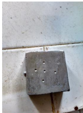
Gambar 4. 8 Titik Uji kekerasan
