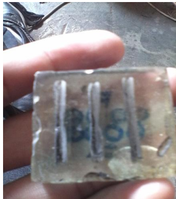
Gambar 4. Spesimen setelah pemotongan dan di mounting
