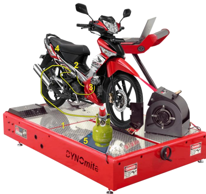
Gambar 2.2 Skema Instalasi Converter kits BBG
